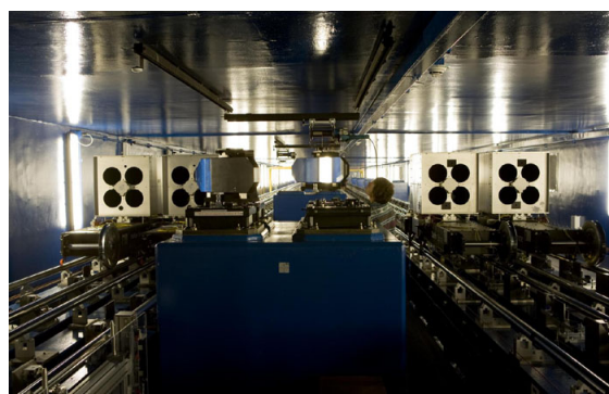
Figur 11. I tunnellerne skal lyset kunne stabiliseres til en brøkdel af lysets bølgelængde for at man reelt kan kombinere lyset fra flere teleskoper (ESO).
